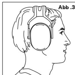
**Abb. 1** Setzen Sie den Gehörschützer so auf, dass die Schalen das Ohr vollständig umschließen und dicht am Kopf sitzen.
