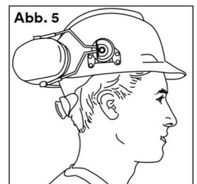
**Abb. 1** Führen Sie die Halterungen in die Aufnahmeschlitze an jeder Helmseite ein, bis sie einrasten.
